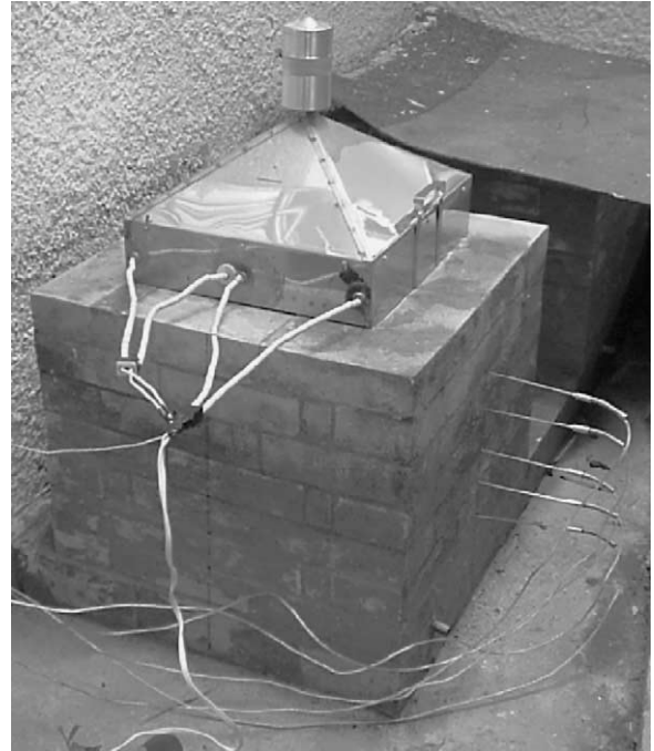
Fig. 9. In situ thermal desorption unit.
